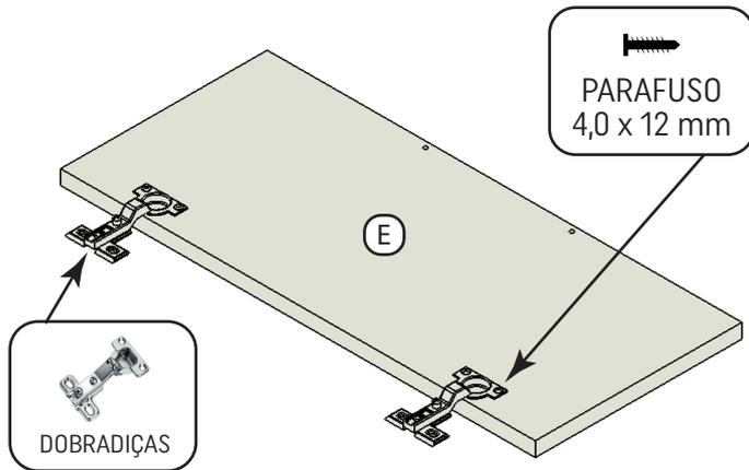
2. Fixe as Portas (E) nas marcações existentes no Fundo e no Tampo Intermediário (D) utilizando os parafusos 4,0 x 12 mm.
