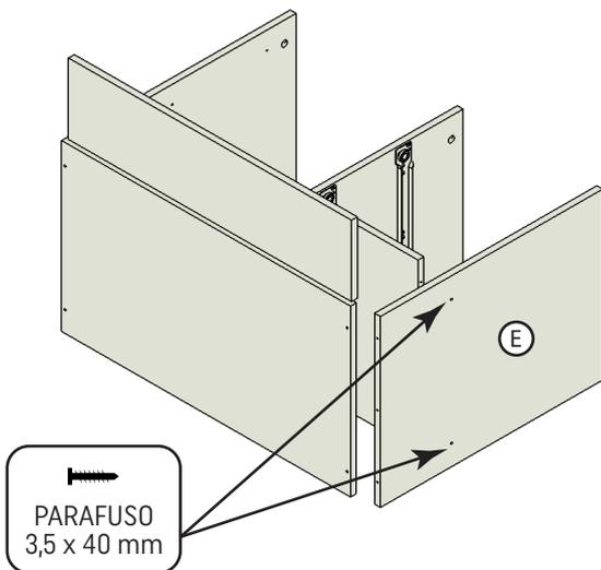
7. Parafuse os mini-fix no Tampo (F), insira as cavilhas e encaixe-o no topo das Laterais (C e E) e na Divisão (A). Aperte-os com as castanhas mini-fix.
