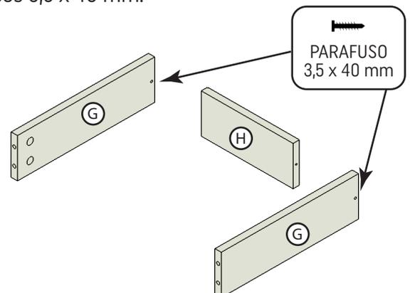
10. Em seguida, insira os parafusos mini-fix na Frente de Gaveta (I), encaixe as laterais (G) e aperte com as castanhas mini-fix. Com a estrutura da gaveta montada, alinhe o Fundo de Gaveta (K) com a Frente de Gaveta (I) e pregue com os pregos.
