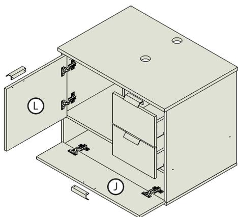
14. Com uma furadeira equipada com broca de 8 mm, faça os furos na parede conforme as marcações das cantoneiras metálicas fixadas no gabinete. Insira as buchas de 8 mm e parafuse com os parafusos 5,0 x 60 mm. A altura recomendada para a borda superior da cuba é entre 85 e 93 cm do chão.
