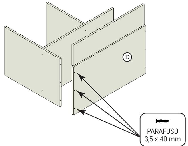
6. Fixe a Lateral Direita (E) ao Tampo Intermediário (B) inserindo a cavilha e apertando com os parafusos 3,5 x 40 mm.
