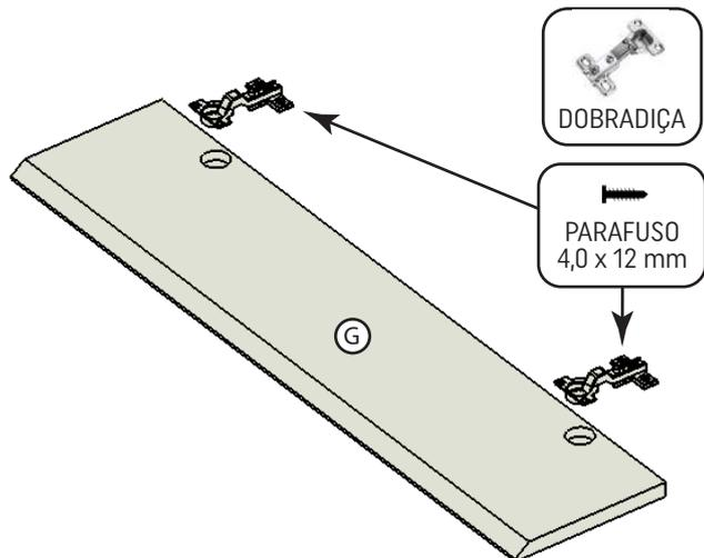
5. Fixe a Porta Basculante (G) nas marcações existentes no Fundo (D) utilizando os parafusos 4,0 x 12 mm.
