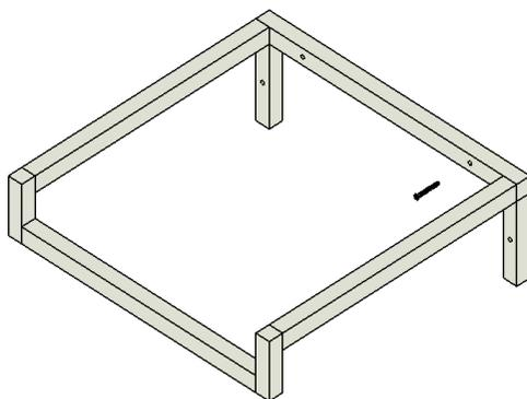
4 – Para melhor fixação e precaução contra eventuais infiltrações, passe silicone na estrutura de ferro onde irá apoiar o tampo.
