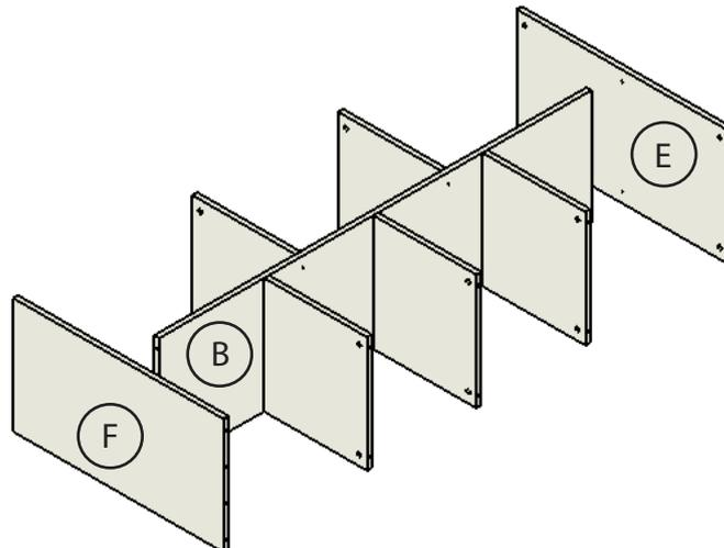
3 - Parafusar os pinos mini fix nas peças C e D, encaixar as cavilha de madeira nas furações nas peças E e F, em seguida encaixe com as demais peças e aperte as castanhas.
