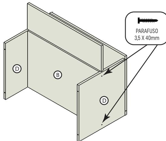
6. Agora encaixe o fundo (E) e fixe com os parafusos 3,5x40mm seguindo as furações existentes.
