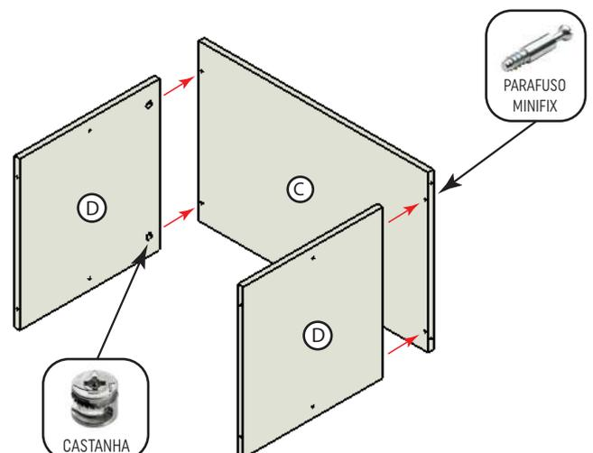
5. Então encaixe o tampo intermediário (B) dentro do módulo e, com os parafusos 3,5x40mm, fixe seguindo as furações presentes nas laterais (D).
