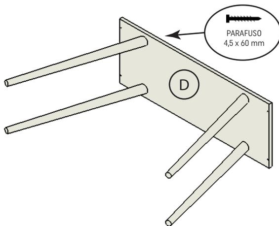
2 - Iniciar a montagem parafusando os pinos mini fix nas furações existente no tampo C. Em seguida encaixe a lateral A e B e aperte com as castanhas.
