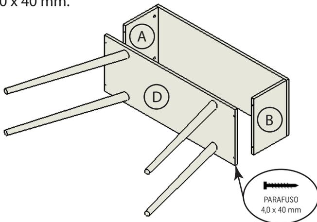
4 - Finalize a montagem usando as sapatas para perfurar os pés, e termine de inseri-las usando o martelo. Cole os tapafuros nas furações onde as castanhas estão inseridas.
