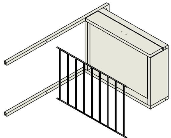
3 – Alinhe a outra estrutura metálica e parafuse com os parafusos 5,0 x 50mm.
