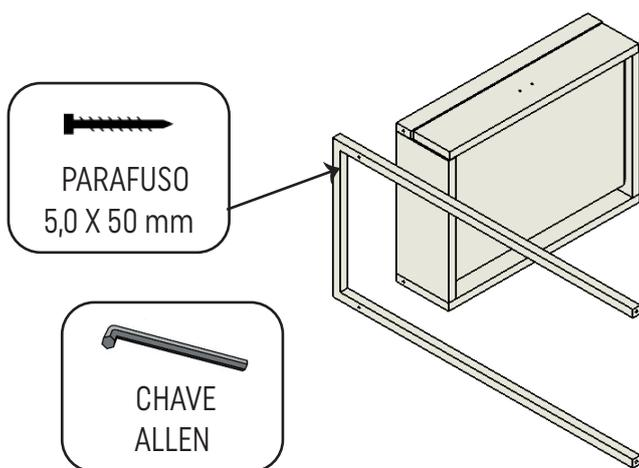
2 – Encaixe o aramado nas furações presentes na estrutura metálica.
