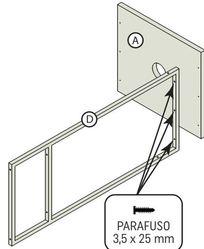
2. Encaixe o Toalheiro (F) na cavidade da Estrutura de Ferro Direita (D) e depois na Estrutura de Ferro Esquerda (E). Após o encaixe, fixe a Estrutura (E) no Tampo (A) com parafusos 3,5 x 25 mm.
