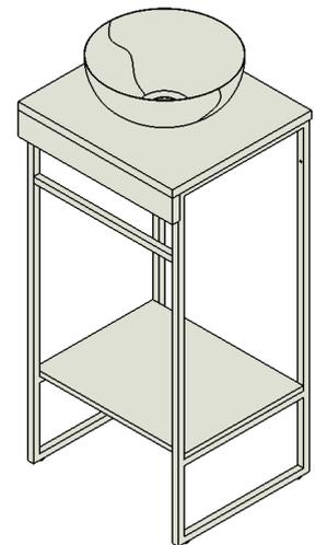
8. Para fixar a cuba, posicione-a sobre o tampo. Em seguida, insira a válvula (não inclusa) na parte interna da cuba e coloque o suporte metálico na parte inferior da válvula, por dentro do gabinete. Por fim, fixe a válvula utilizando a rosca.
