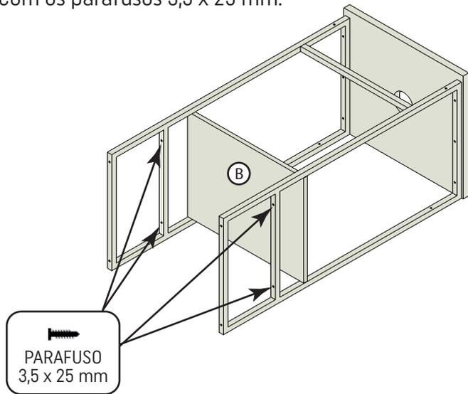
4. Alinhe a Barra Dianteira (C) na parte frontal do Tampo (A), seguindo as furações nas Estruturas, e fixe com parafusos 3,5 x 25 mm.
