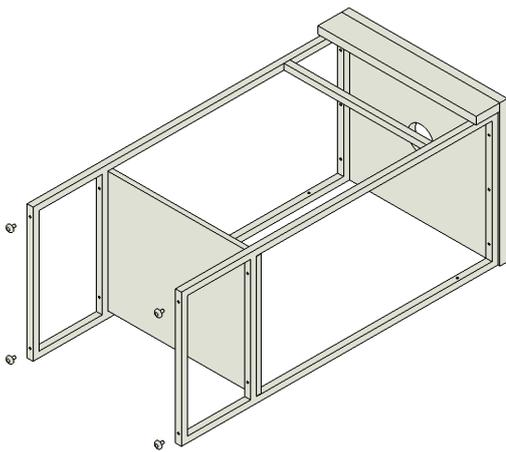
6. Com a furadeira e broca de 6 mm, faça os furos na parede, seguindo as furações presentes na estrutura metálica.
