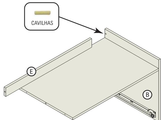
4. Repita o processo com a Lateral Esquerda (C), insira uma cavilha na furação central da lateral, encaixe-a no Tampo (A) e na Barra Traseira (E). Fixe a lateral com os parafusos 3,5 x 40 mm.
