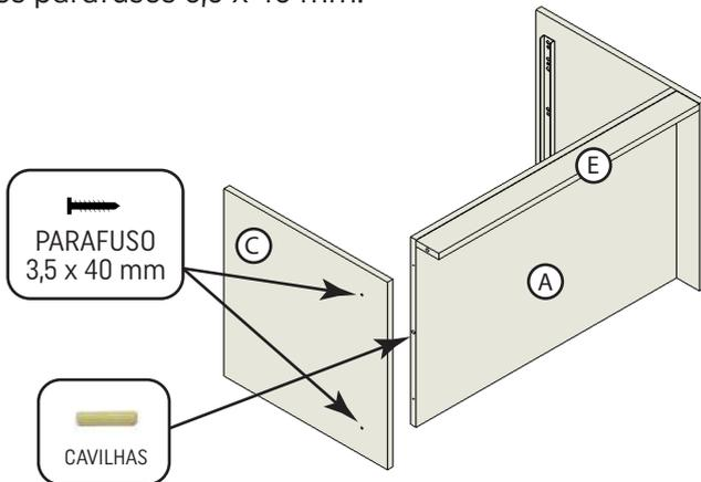
5. Posicione o Fundo (D) entre as laterais (B e C) e fixe-o utilizando parafusos 3,5 x 40 mm.
