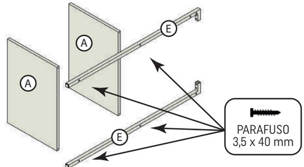
02. Repita o processo com as outras duas Estruturas Metálicas Pé Menor (E) no lado esquerdo, fixando também com os parafusos 3,5 x 40 mm.
