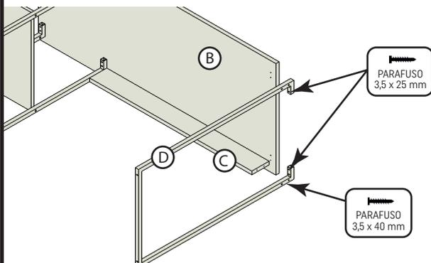
7. Encaixe as sapatas nas extremidades da Estrutura Metálica Pé Maior (D).
