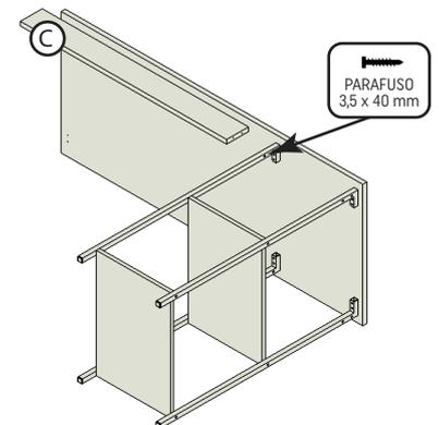
6. Alinhe a última Estrutura Metálica Pé Maior (D) e fixe-a no Tampo (B), utilizando os parafusos 3,5 x 25 mm, e na Barra Traseira (C), utilizando os parafusos 3,5 x 40 mm.
