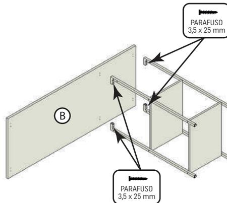
04. Fixe a Barra Traseira (C) na estrutura metálica, utilizando os parafusos 3,5 x 40 mm. Ela pode ser instalada em ambos os lados, a depender do lado que desejar manter as prateleiras.
