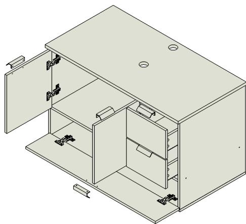
14. Com uma furadeira equipada com broca de 8 mm, faça os furos na parede conforme as marcações das cantoneiras metálicas fixadas no gabinete. Insira as buchas de 8 mm e parafuse com os parafusos 5,0 x 30 mm. A altura recomendada para a borda superior da cuba é entre 85 e 93 cm do chão.
