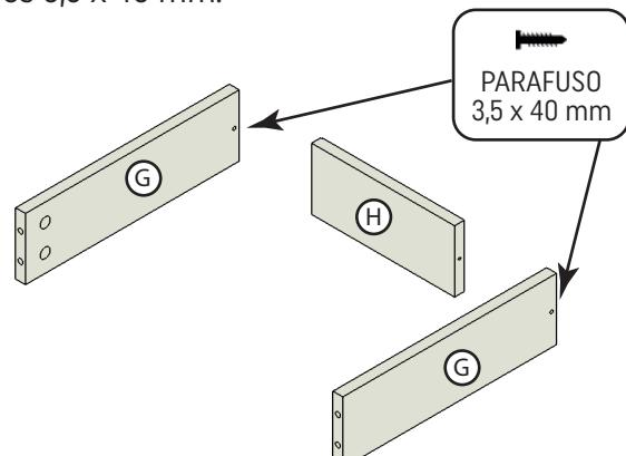
10. Em seguida, insira os parafusos mini-fix na Frente de Gaveta (I), encaixe as laterais (G) e aperte com as castanhas mini-fix. Com a estrutura da gaveta montada, alinhe o Fundo de Gaveta (K) com a Frente de Gaveta (I) e pregue com os pregos.
