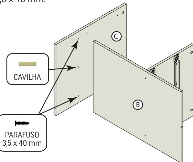
6. Fixe a Lateral Direita (E) ao Tampo Intermediário (B) inserindo a cavilha e apertando com os parafusos 3,5 x 40 mm.
